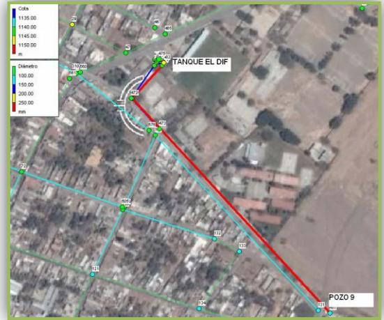
El tanque el DIF es alimentado desde el pozo 9 por medio de una línea de conducción con tubería de acero de 10" de diámetro y cuenta con una longitud de 591 m aproximadamente.
